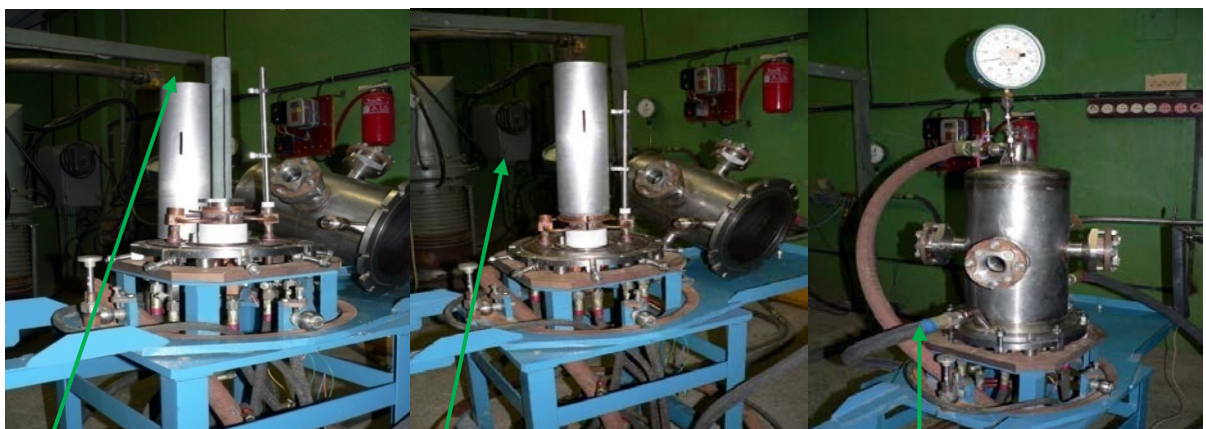
Нагреватель из УУКМ с прорезью
