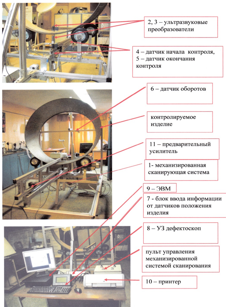
Рис. 3. Автоматизированная установка для комплексной многоканальной дефектоскопии сложнопрофильных среднегабаритных конструкций из полимерных и углеродсодержащих КМ
